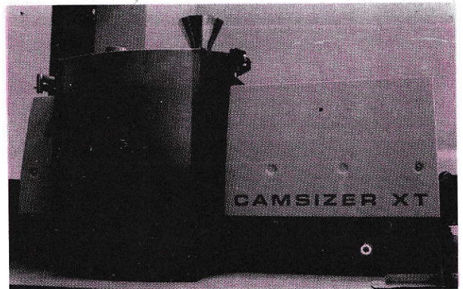
H.1. Thiết bị tự động phân tích kích thước các hạt CAMSIZER XT
