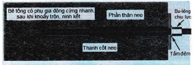
H.4. Kết quả khoan và lắp đặt vì neo BTCT trong đất đá có chứa nước ngầm
