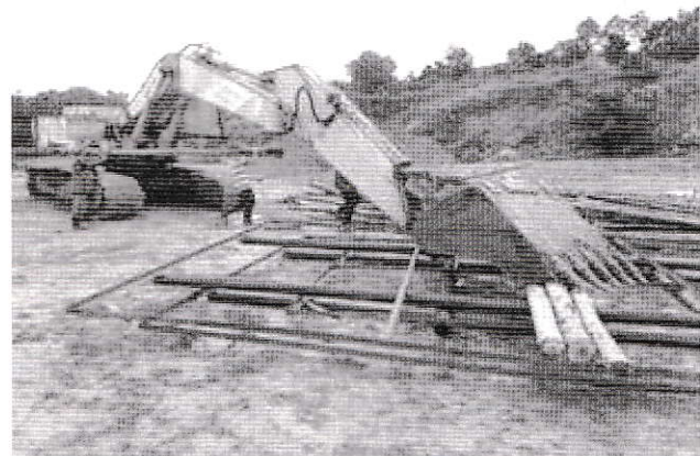
H.6. Thiết bị tham gia thử nghiệm: a - Ô tô tải 7 tấn; b - Máy xúc thủy lực gầu ngược bánh xích 0,7 m 3
