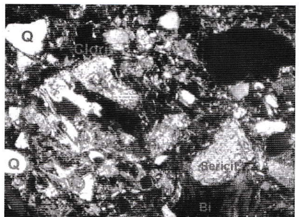
Ảnh 2. Cát kết Grauvac, xi măng sét (Ảnh dưới kính SHM: N36-33808 (2N+))
