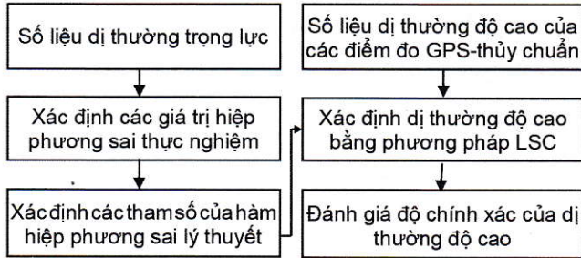
H.1. Sơ đồ quy trình xác định dị thường độ cao từ số liệu dị thường trọng lực kết hợp với số liệu dị thường độ cao GPS-thủy chuẩn theo phương pháp LSC
