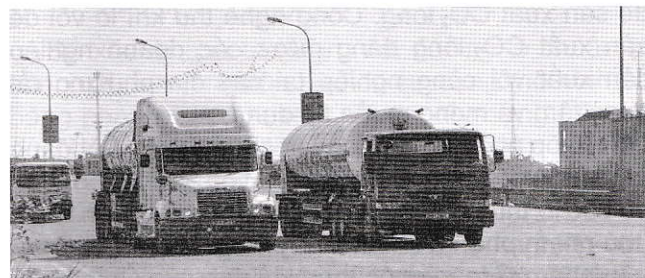
H.5. Bồn chứa và xe bồn chuyên dụng vận chuyển CO 2 lỏng đến nơi tiêu thụ
