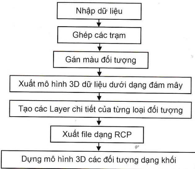
H.1. Quy trình xử lý số liệu quét 3D laser mặt đất
