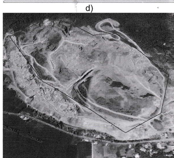
H.7. Mô hình số độ cao và ranh giới tính trữ lượng: a - DEM lập từ số liệu đo toàn đạc; b - DEM lập từ dữ liệu UAV; c - DEM địa hình thiết kế kết thúc khai thác; d - Ranh giới tính trữ lượng
