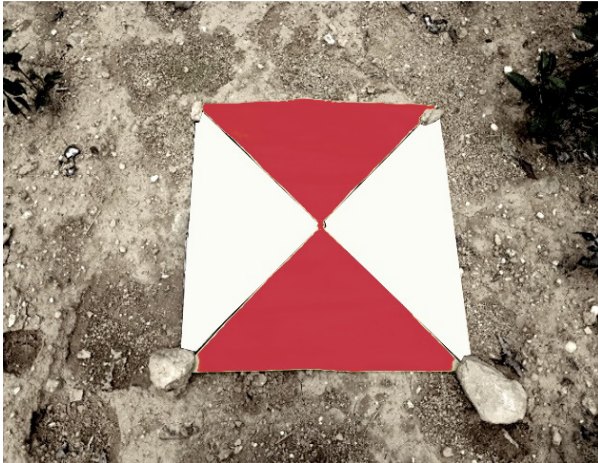
H.2. Điểm khống chế ảnh, đo tọa độ và độ cao các GCPs và Check points bằng thiết bị GNSS/RTK.
