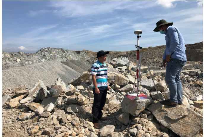
H.2. Điểm khống chế ảnh, đo tọa độ và độ cao các GCPs và Check points bằng thiết bị GNSS/RTK.
