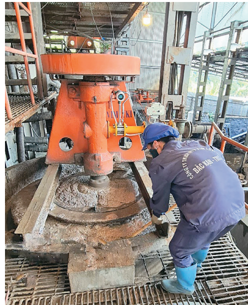
H. 5. Lắp đặt và chạy thử nghiệm thiết bị tuyển nổi tankcell chế tạo tại nhà máy tuyển chì kẽm Chợ Điền
