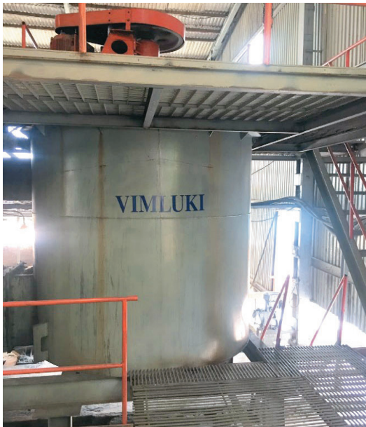
H. 5. Lắp đặt và chạy thử nghiệm thiết bị tuyển nổi tankcell chế tạo tại nhà máy tuyển chì kẽm Chợ Điền
