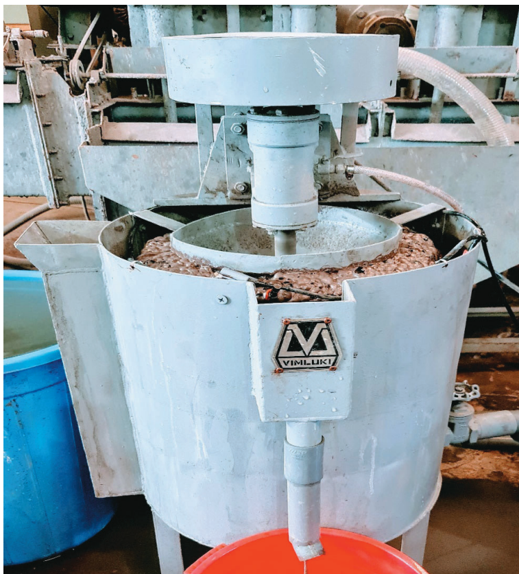
H.2. Thiết bị tuyển nổi tankcell 80 lít chế tạo của Đề tài
