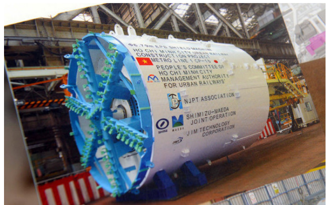
H.5. Hình ảnh máy khoan hầm đang sử dụng tại Việt Nam: a - Tuyến số 3 tại Hà Nội; b - Máy khiên đào tuyến số 1 tại Tp. Hồ Chí Minh
