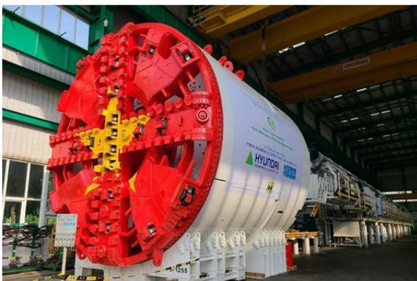
H.5. Hình ảnh máy khoan hầm đang sử dụng tại Việt Nam: a - Tuyến số 3 tại Hà Nội; b - Máy khiên đào tuyến số 1 tại Tp. Hồ Chí Minh
