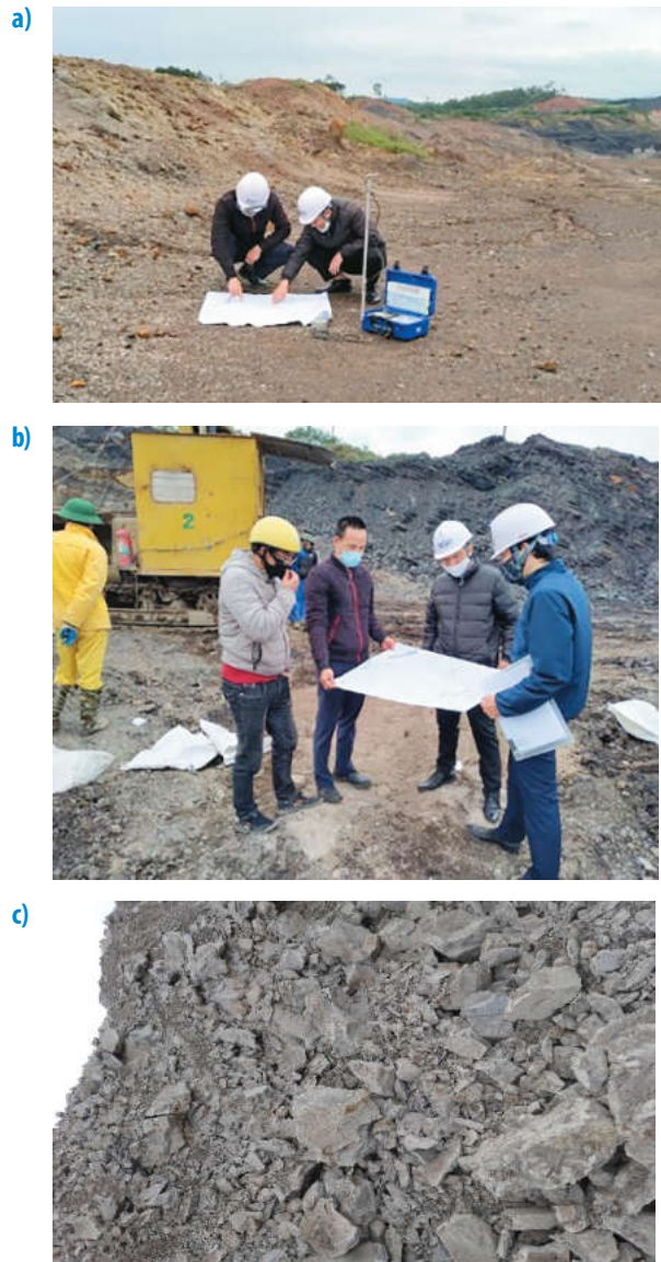
H.6. Một số hình ảnh về công tác thử nghiệm giải pháp nổ mìn giảm chấn động sử dụng đường kính lỗ khoan D = 160mm trên bờ trụ.
