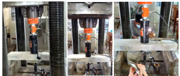
H.4. Lắp đặt các mẫu thí nghiệm TCL1, TCL2, TCL3 và các thiết bị
