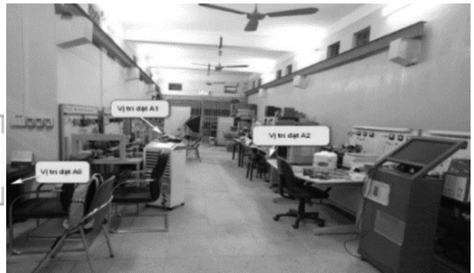
H.8. Kịch bản thử nghiệm hệ thống RTLS trong phòng thí nghiệm
