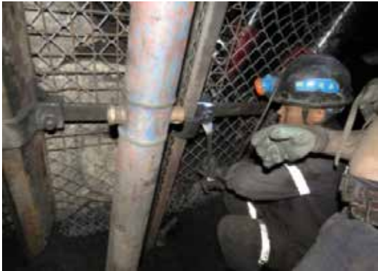
Hình 5. Kết cấu tường chắn để ngăn đất đá phá hỏng lò DVVT phía tiếp giáp với lò chợ đã khai thác
