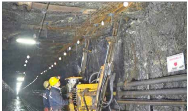
H.10. Công tác khoan nổ mìn cắt vách định hướng
