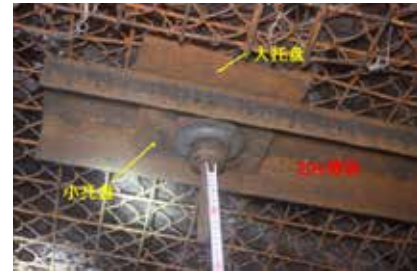
H.2. Kết cấu và nguyên lý làm việc của neo cáp NPR
