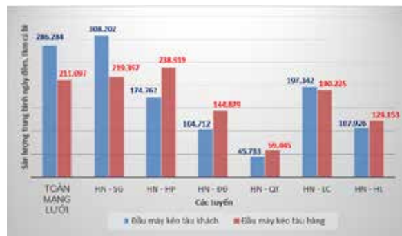
H.16. Biểu đồ sản lượng trung bình ngày đêm của đầu máy trên đường sắt quốc gia Việt Nam tính trung bình cho giai đoạn 2015-2020 theo các tuyến
