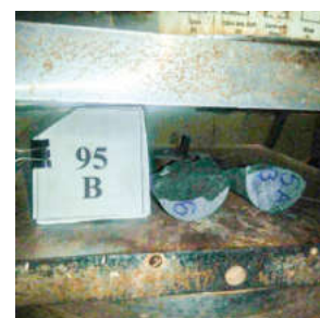
H.25. Mẫu 95B - thí nghiệm kháng kéo
