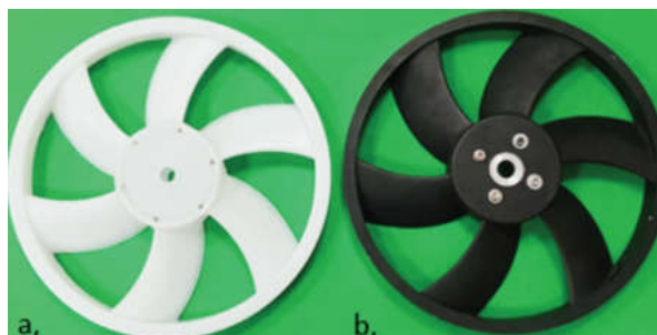
H.3. Hình ảnh (a) quạt đúc ly tâm và (b) quạt đối xứng
