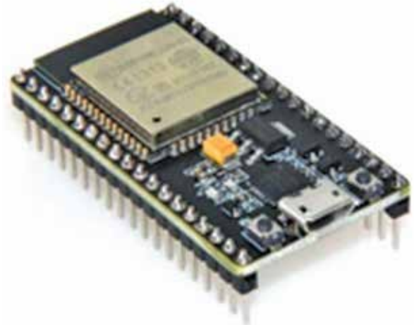
Hình 1. Hình dạng và tham số kỹ thuật ESP32 [20]
