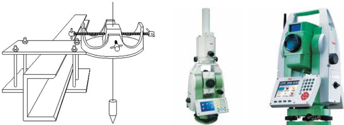
Hình 6. (a) Đĩa định vị gắn trên khung thép, (b) Máy kinh vĩ con quay và (c) Máy Leica FlexLine TS09
