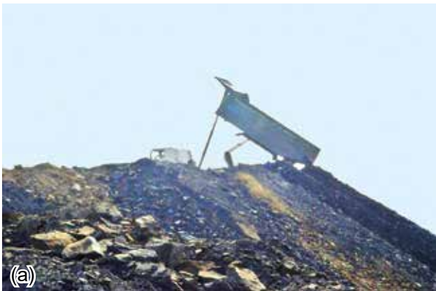
Hình 2. Bãi thải đổ thải cao (a) và đổ thải phân tầng (b) (Ảnh: Trần Miên)
