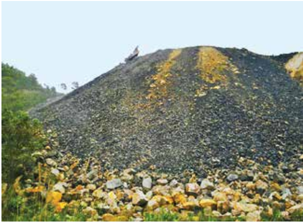
Hình 1. Sự phân bố cỡ hạt trên sườn tầng bãi thải (Ảnh: Trần Miên)
