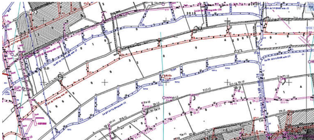
Hình 8. Sơ đồ một số đường lò điển hình có tiết diện 9-15 m 2 dự kiến thu hồi vì chống tại mỏ than Mạo Khê
