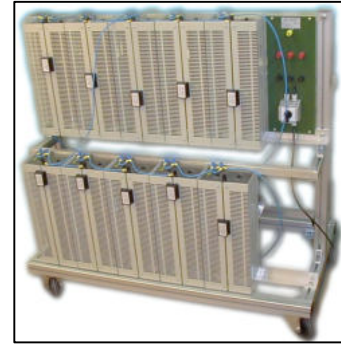
c) Tổ hợp thử nghiệm thiết bị điện gia dụng TCVN 5699/ IEC 60335
