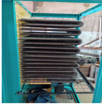
b) Tải giả điện trở dạng dây quấn thử nghiệm máy phát điện;
