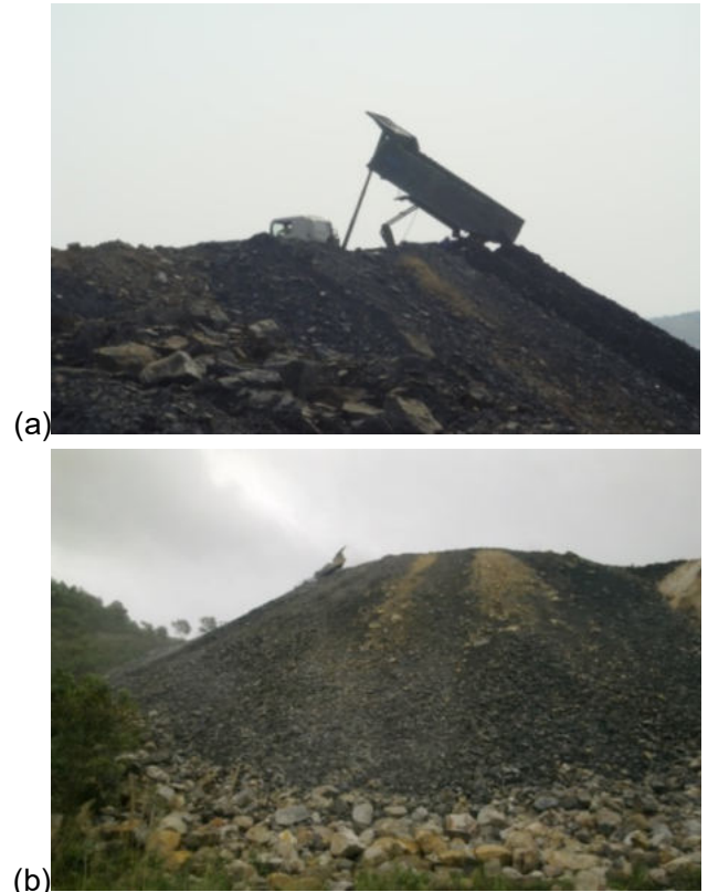
Hình 1. Hiện trạng công tác đổ thải đất đá mỏ (Ảnh: Trần Miên)
