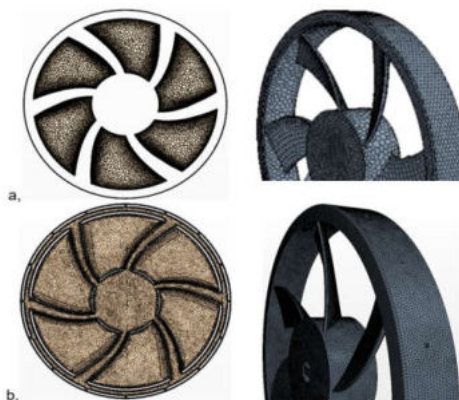
Hình 4. a - Chia lưới cánh quạt không điều chỉnh, b - cánh quạt có điều chỉnh bằng khí nén
