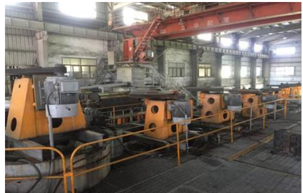
Hình 12. Máy tuyển nổi Tankcell tại Nhà máy tuyển đồng Sin Quyền 1 [1]
