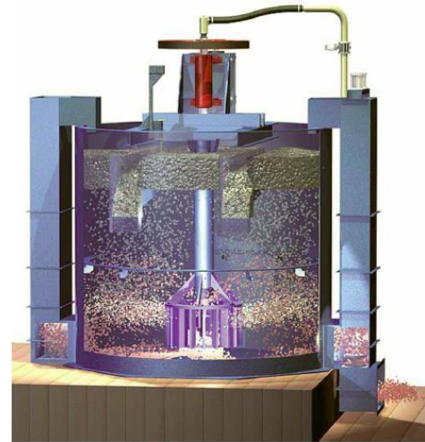
Hình 2. Mô hình ngăn máy RCS của hãng Metso [5]
