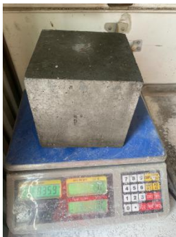
Hình 5. Xác định khối lượng, kích thước và độ sụt của mẫu bê tông thí nghiệm
