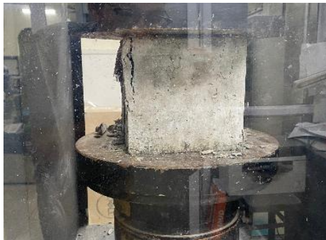
Hình 7. Hình ảnh mẫu bị phá hoại
