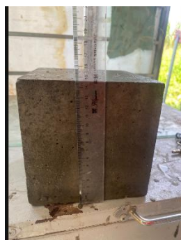
Hình 5. Xác định khối lượng, kích thước và độ sụt của mẫu bê tông thí nghiệm
