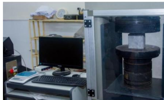
Hình 8. Hệ thống máy nén uốn tự động ADVANTEST 9
