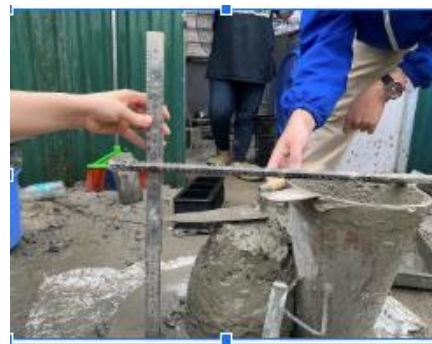
Hình 5. Xác định khối lượng, kích thước và độ sụt của mẫu bê tông thí nghiệm
