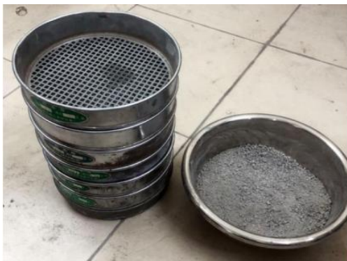
Hình 2. Bộ sàng tiêu chuẩn dùng xác định thành phần cỡ hạt của cát sản xuất từ đá thải mỏ
