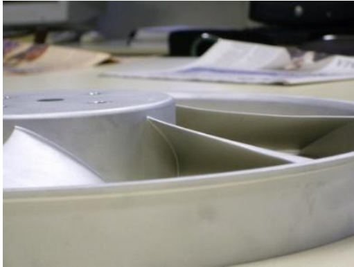
Hình 7. Quạt tham chiếu chế tạo bằng nhôm có chiều dày cánh 4mm và 10 mm
