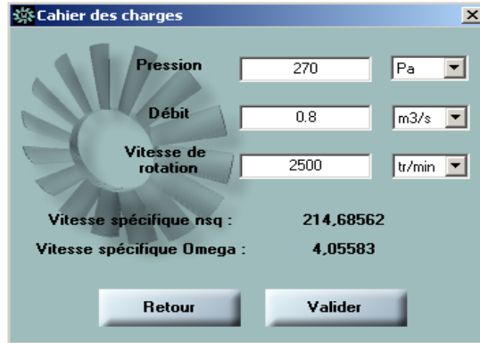
Hình 2. Thông số kỹ thuật của quạt thiết kế trên phần mềm MFT
