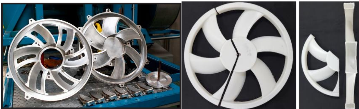
Hình 12. Cánh quạt được chế tạo bởi phương pháp đúc ly tâm (cánh quạt rỗng ở giữa)
