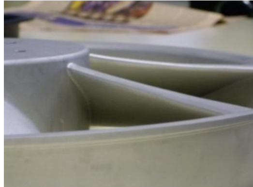
Hình 7. Quạt tham chiếu chế tạo bằng nhôm có chiều dày cánh 4mm và 10 mm
