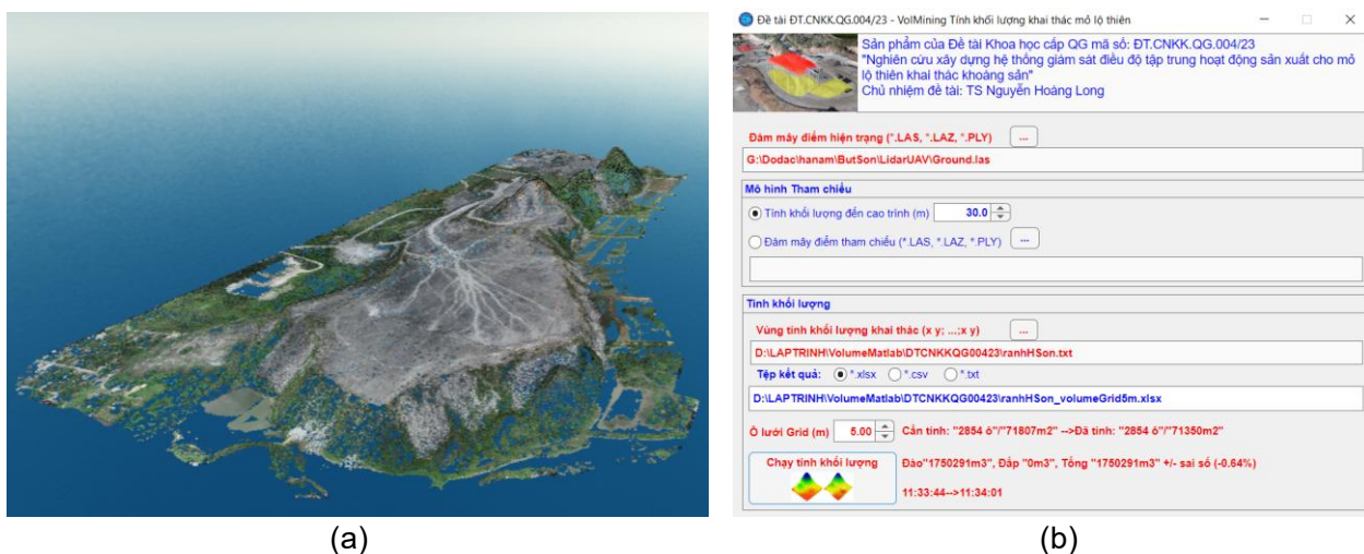
Hình 4. a) dữ liệu đám mây điểm đầu vào của mỏ đá Hồng Sơn; b) kết quả tính toán từ VolMining
