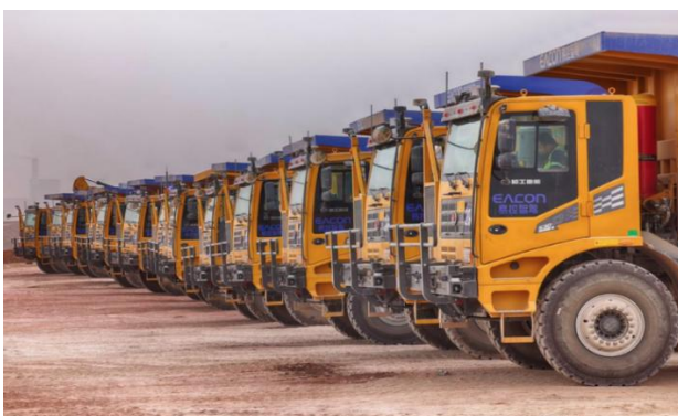
Hình 1. Xe tải tự hành dùng cho mỏ lộ thiên South Pit, Trung Quốc
