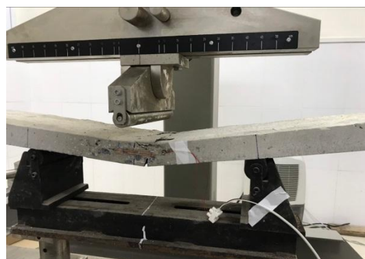
Hình 13. Chế tạo và thí nghiệm tấm chèn sử dụng tro bay thay thế xi măng
