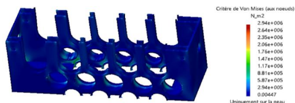
Hình 14. Kết quả phân tích ứng suất thân máy trên
