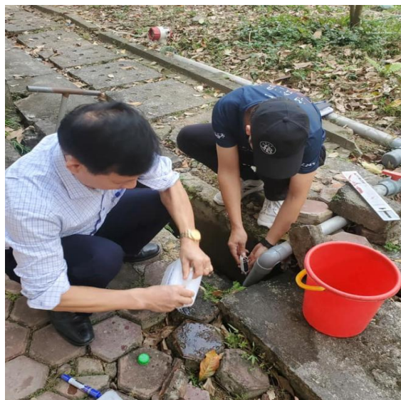
Hình 10. Hình ảnh lấy mẫu nước khoáng và kiểm tra nhiệt độ nước khoáng tại thực địa
