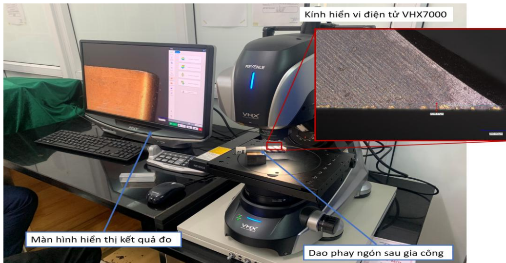
Hình 10. Sơ đồ đo mòn dao bằng kính hiển vi kỹ thuật số VHX-7000
