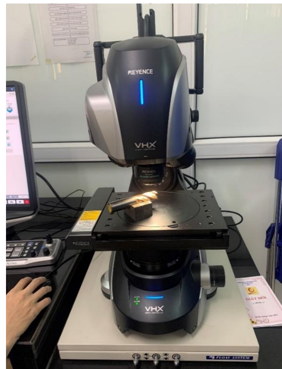
Hình 3. Đo độ mòn của dụng cụ bằng kính hiển vi kỹ thuật số VHX-7000
