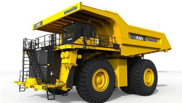
Hình 4. Xe tải khai thác 930E của Komatsu sẽ chạy bằng pin nhiên liệu hydro [12]
