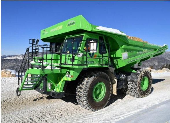
Hình 3. Xe tải khai thác mỏ nặng 111 Tấn của Komatsu đã được chuyển sang hoạt động bằng điện với bộ pin điện lithium-iron-phosphate 600 kWh [10]
