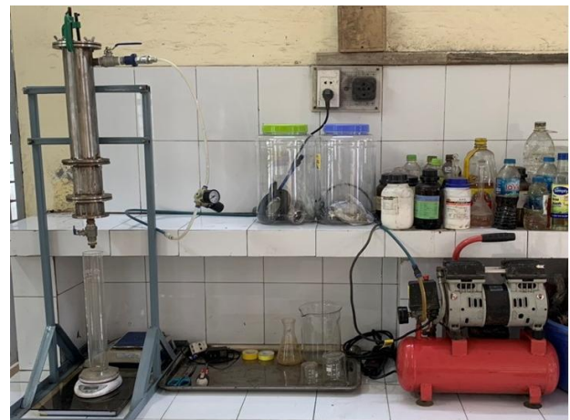
Hình 2. Hình ảnh thiết bị lọc tăng áp dạng ống được chế tạo và đặt tại phòng thí nghiệm Tuyển khoáng và Môi trường, Trường Đại học Mỏ - Địa chất
