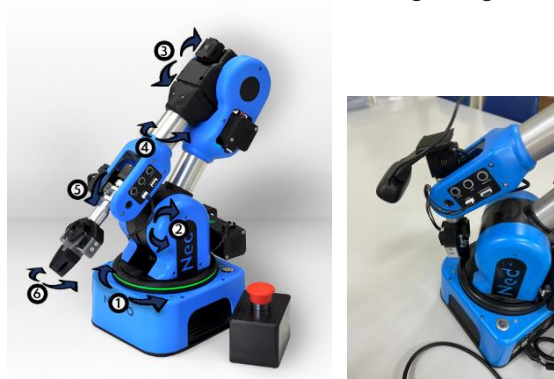
Hình 4. Cánh tay Niryo Ned 2 và tích hợp camera lên cánh tay máy
