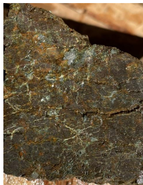
Ảnh 5. Quặng sulfur bị oxy hóa hoàn toàn tại độ sâu 11,1m LK BP21-12 [4]
