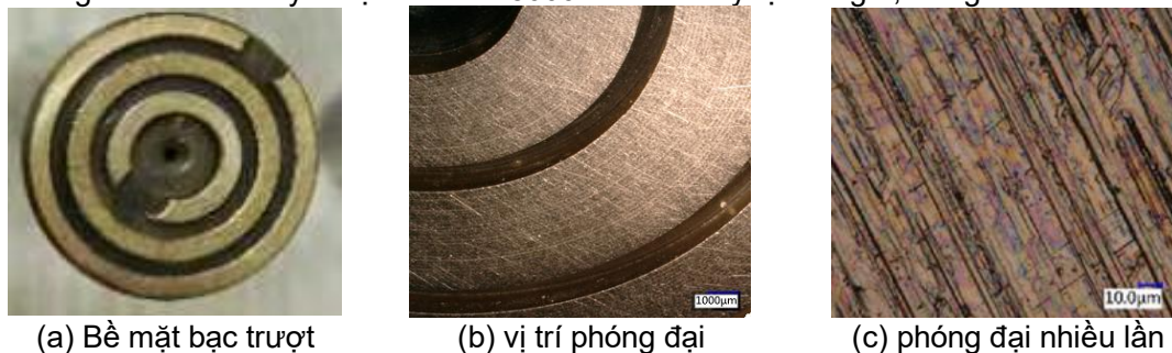
Hình 4. Hình thái bề mặt bạc trượt không kết cấu vi mô trước mài mòn
