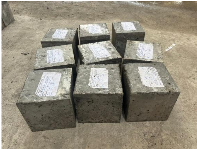
Hình 11. Khuôn đổi mẫu bê tông thí nghiệm kích thước 10x10x10cm
