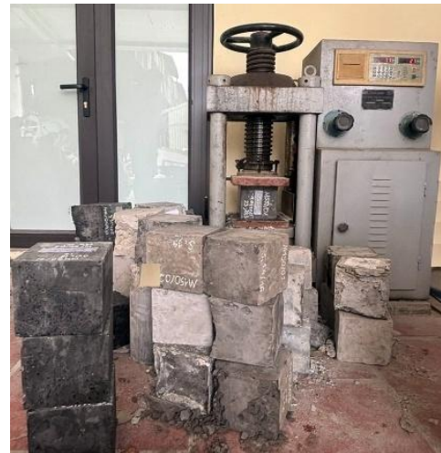
Hình 12. Hệ thống máy nén xác định cường độ của mẫu thí nghiệm
