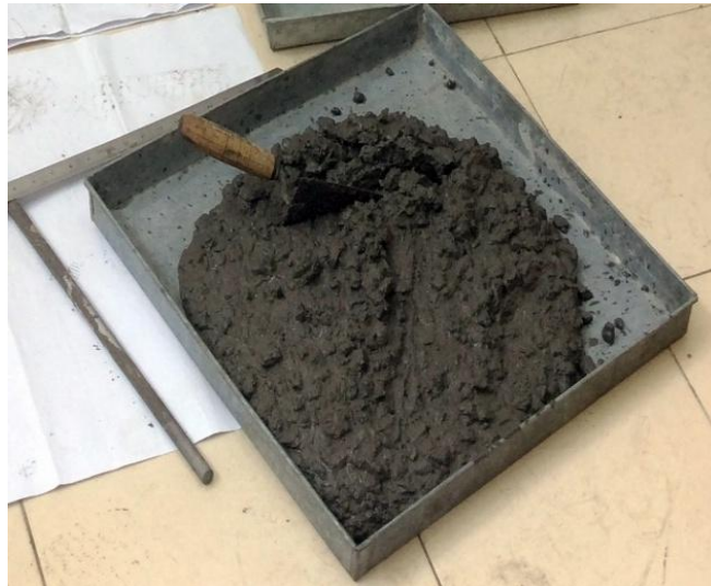
Hình 7. Hỗn hợp bê tông xanh sử dụng bùn thải sau khi nhào trộn
