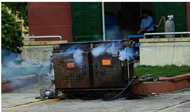
Hình 9. Hình ảnh thử nổ của vỏ tổ hợp cầu dao chân không
