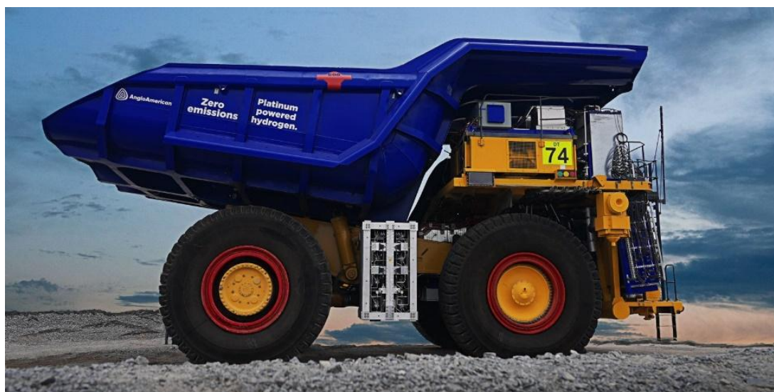
Hình 2. Xe tải mỏ lai pin nhiên liệu và pin điện
