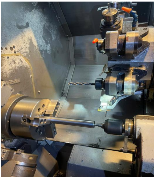
Hình 1. Dụng cụ cắt và mẫu phôi SKD11 dùng trong thí nghiệm
