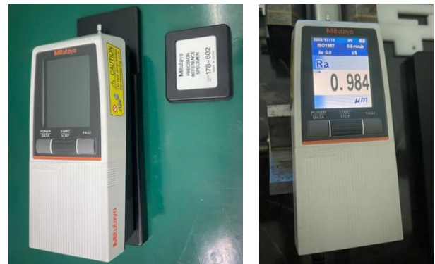
Hình 3. Thiết bị đo độ nhám Mitutoyo SJ-210
