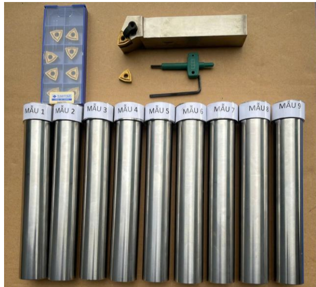
Hình 1. Dụng cụ cắt và mẫu phôi SKD11 dùng trong thí nghiệm
